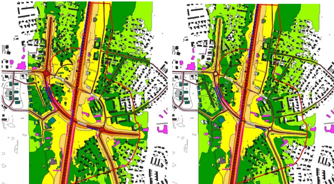
Päiväajan (vas.) ja yöajan (oik.) keskiäänitaso ennustetilanteessa Aseman ympäristössä ja Riihivainiolla. Tummanvihreä tasoa 50...55. (WSP 2024)
